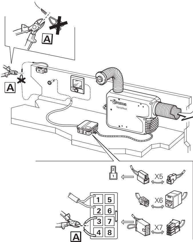
Fig. 23 – Wiring diagram
